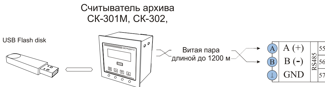
Рис 5.5 Типовая схема подключения прибора к считывателям архива.
